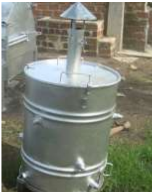
Gambar 3. Pirolisator terbuat dari drum
