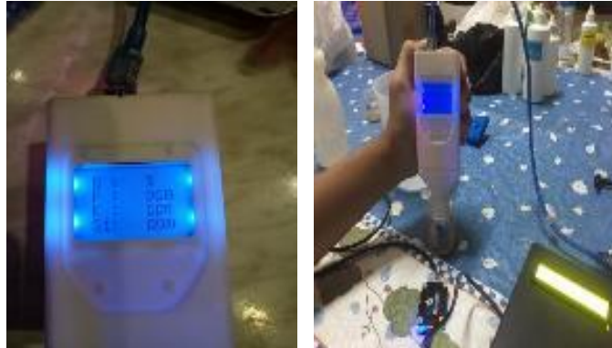
Gambar 9. Keragaan Prototype Perangkat Uji Tanah Sawah Digital untuk Tanaman Pangan
